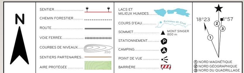
PROJECTION CARTOGRAPHIQUE : TRANSVERSE DE MERCATOR • SYSTÈME DE RÉFÉRENCE GÉODÉSIQUE : NAD83, ZONE 18 LA GRILLE UTM FAIT UN ANGLE DE 1°57' PAR RAPPORT AU BORD DE LA CARTE • ÉQUIDISTANCE DES COURBES DE NIVEAU : 10 M LA DÉCLINAISON MAGNÉTIQUE EST DE 18°23' AVEC UNE DÉCROISSANCE ANNUELLE DE 0,2" DEPUIS 2000
